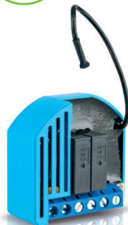
Steuert motorisierte Jalousien, Rollläden und Markisen. Automatischer Austausch von Statusmeldungen zum Gateway. Eingebaute Repeater-Funktion für größere Reichweite.
